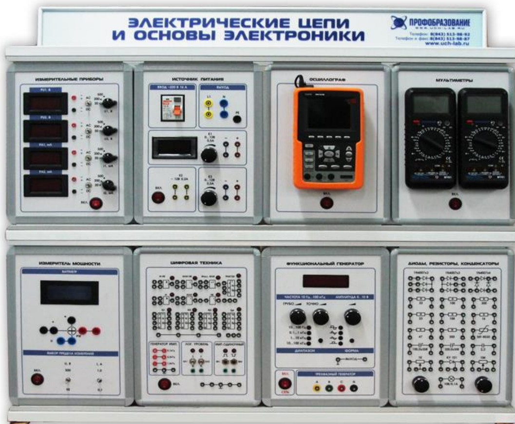
Рисунок 1 – Комплект учебно-лабораторного оборудования «Электрические цепи и основы электроники» ЭЦОЭ-СР
